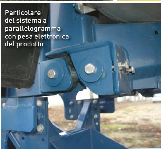
Particolare del sistema a parallelogramma con pesa elettronica del prodotto
