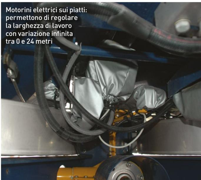
Motorini elettrici sui piatti: permettono di regolare la larghezza di lavoro con variazione infinita tra 0 e 24 metri
