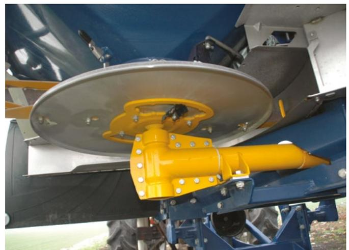
Trasmissione senza manutenzione e con frizione di sicurezza, uno degli aspetti di cui Bogballe va più fiera
