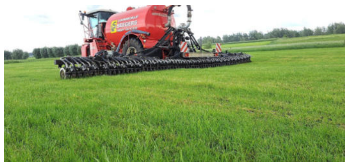
Quadro Disc, iniettore combinato a dischi per cereali
