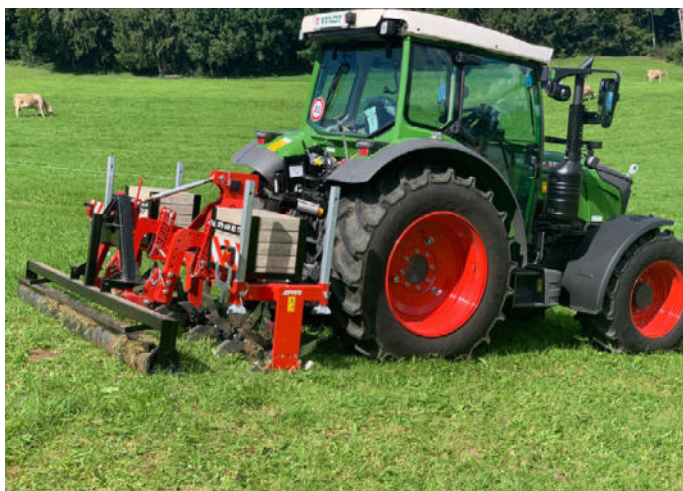
Freiberger, iniettore ad ancore rigide
