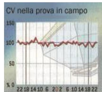
**Il CV di Bogballe del 3.7% era il valore più basso nel test.**
