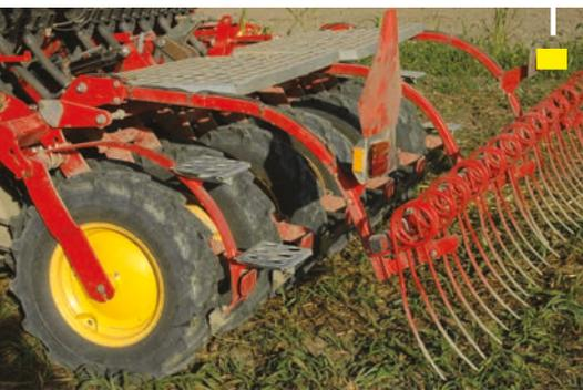
**1** Ruote di compattamento con funzione di regolazione della profondità e della pressione al suolo
