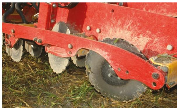
Nel sistema Rapid due elementi di semina fanno capo alla stessa ruota di profondità
