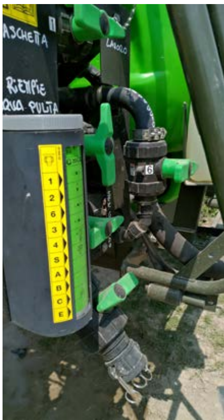
Indicatore di livello visibile dalla cabina, al pari del manometro per la pressione di esercizio
