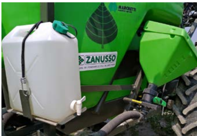
Riserva di acqua pulita da 15 litri per il lavaggio delle mani
