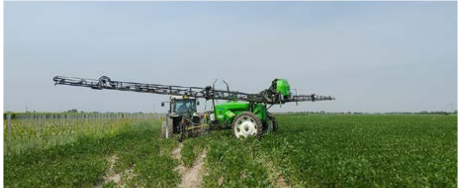
Il sistema di bilanciamento assicura stabilità anche nelle svolte a fine campo
