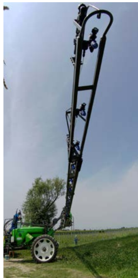
Barra in acciaio da 24 metri, divisa in sezioni
