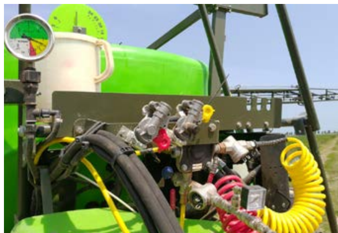
La macchina utilizza un sistema pneumatico per la gestione della barra. Serve quindi un trattore dotato di compressore
