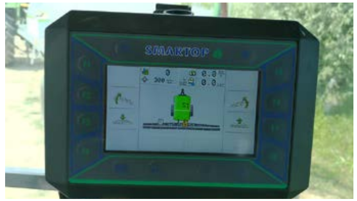
Terminale Isobus per la gestione dei trattamenti e la raccolta dei dati sul lavoro effettuato
