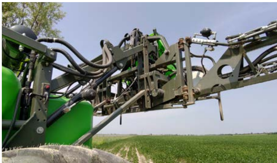
Buon sistema di ammortizzamento per il parallelogramma
