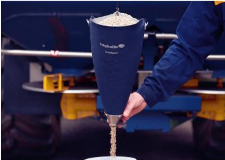
**S-indicator** – controllo statico del flusso (standard **L + M Line** con comando idraulico)
