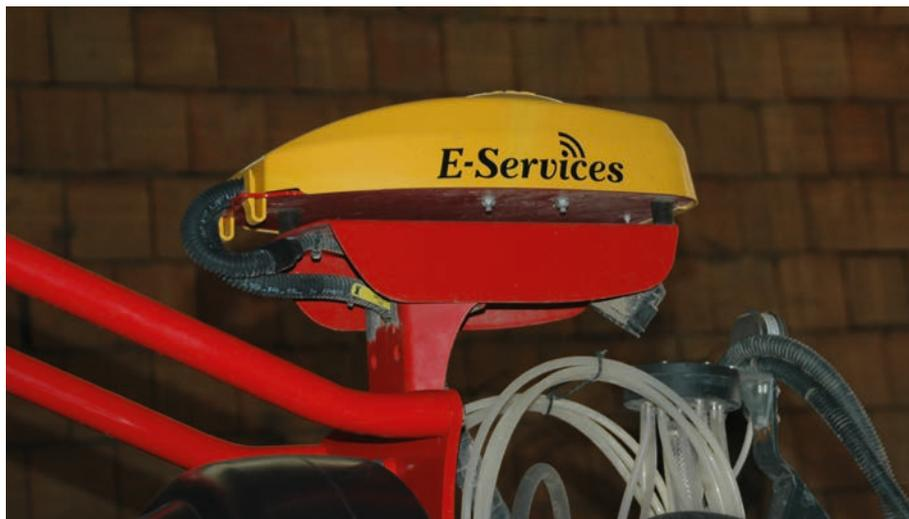
Antenna Gateway, il "cervello" della Tempo. Oltre al ricevitore Gps, contiene l'antenna che invia i dati alla cabina in wireless
