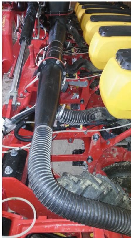
**La ventola, azionata da un distributore idraulico, crea aria sufficiente per il trasporto del seme fino al distributore e per il sistema Powershoot.**
