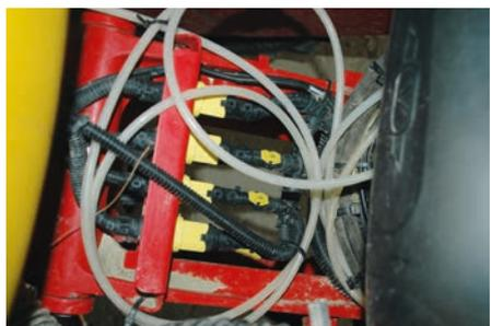
La gestione elettrica del disco distributore rende possibile variare i dosaggi durante il lavoro e chiudere un singolo elemento per evitare sovrapposizioni.
