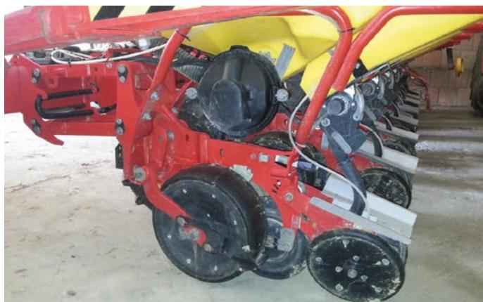
L'elemento di semina carica sul disco fino a 325 kg, di cui 150 dati dalle molle di compressione, indispensabili per fare sodo.
