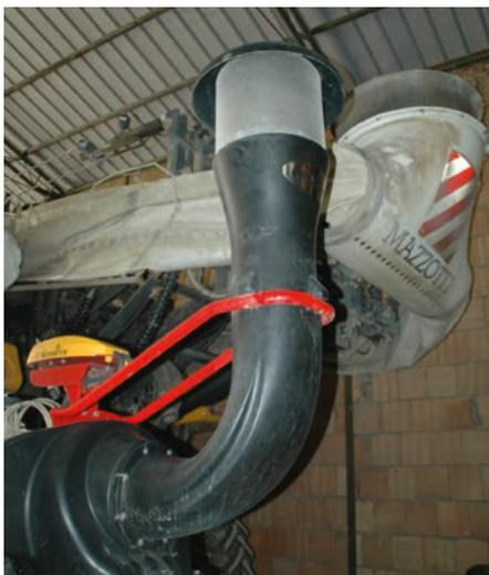
La presa d'aria rialzata riduce l'ingresso di polvere nel dosatore.
