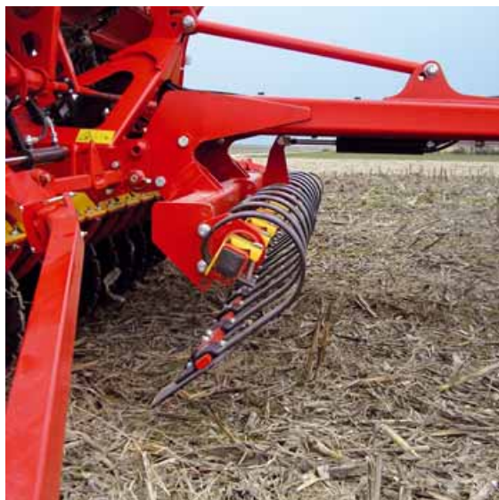
La barra livellatrice anteriore è regolabile idraulicamente e può essere esclusa nel caso in cui la macchina venga impiegata su sodo. Su terreno lavorato è in grado di esercitare un'energica azione di pareggiamento
