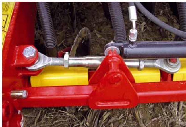
Vite distanziatrice utilizzabile per la traslazione laterale del rango anteriore di dischi rispetto a quello posteriore
