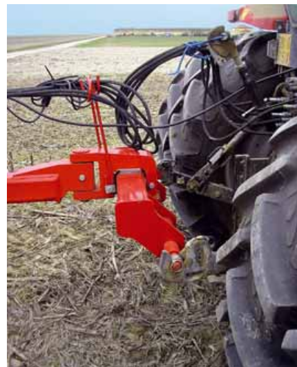
La barra di traino è dotata di un dispositivo per l'accoppiamento al sollevatore del trattore
