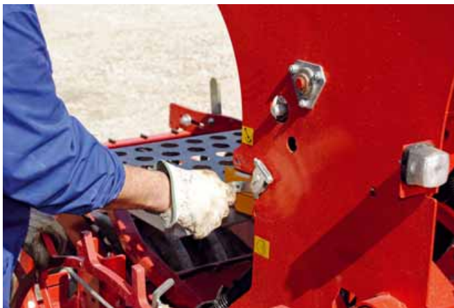
Il rullo di distribuzione è dotato di una leva per aprire/chiedere manualmente l' erogazione del seme o del concime
