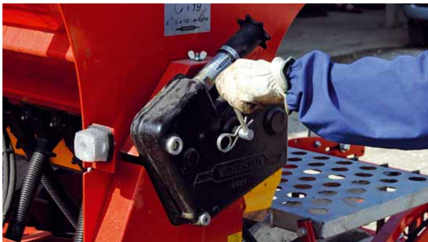
La scatola del cambio , con ingranaggi stellati e trasmissione a catena, è posizionata lateralmente e facilmente accessibile all'operatore
