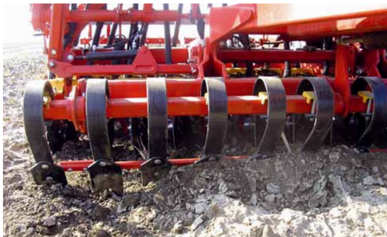
La barra livellatrice anteriore è regolabile idraulicamente e può essere esclusa nel caso in cui la macchina venga impiegata su sodo. Su terreno lavorato è in grado di esercitare un'energica azione di pareggiamento
